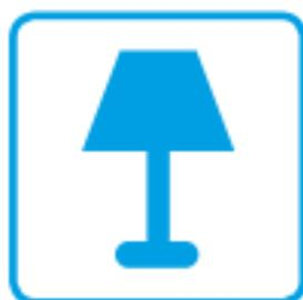
Diese Leuchte enthält eingebaute LED-Lampen.
